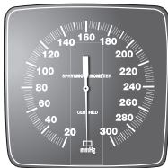
Aguja adecuadamente fijada en la posición de cuadro cero
