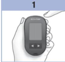
Pulse y suelte ① (botón Power/Set) para encender el medidor.
