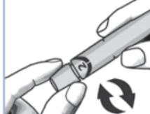
Ajuste el selector de profundidad de punción.
