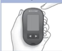
Pulse y suelte ① para encender el medidor. El símbolo de la tira reactiva parpadeando aparece en la pantalla. Pulse y **mantenga pulsado** ② hasta que aparezca set-up en la pantalla.
