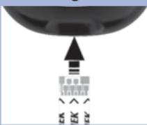
Inserte la tira reactiva en el medidor según la dirección de las flechas. El medidor se enciende y emite una señal sonora.
