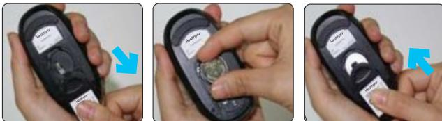
Das Healthpro-X1 Blutzucker-Messgerät ist ausschliesslich für den Betrieb mit zwei 3V-Lithium-Batterien (CR2032, im Lieferumfang enthalten) bestimmt. Verwenden Sie beim Batteriewechsel nur CR2032- oder gleichwertige Lithiumbatterien.
