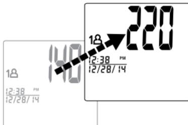
4. Cuando haya finalizado la medición, el brazalete se desinflará por completo y se mostrarán las lecturas de presión sistólica, presión diastólica y pulso simultáneamente en la pantalla LCD. **La medición se almacenará automáticamente en la memoria.**
