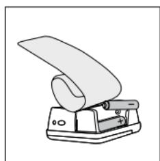
3. Instale la otra batería siguiendo las indicaciones de polaridad que se encuentran en el interior del compartimiento (según se muestra en la figura 3).
