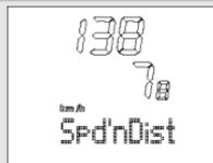
Sobald Sie im Menü **Spd'nDist** sind, wechselt Ihre Pulsuhr automatisch in die Hauptanzeige. Diese zeigt in der mittleren Zeile die aktuelle Geschwindigkeit an. Die untere Zeile zeigt die durchschnittliche Herzfrequenz an.
