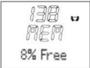
The image shows a digital display with the number '138' at the top, 'MEM' in the middle, and '8% Free' at the bottom.      | Während des Trainings meldet die Pulsuhr alle 5 Sekunden <b>MEM x% Free</b> , wenn weniger als 10% des Speichers frei sind.<br>Auf dem Bild: <b>MEM 8% Free</b> (noch 8% frei).                |
