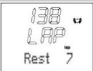
The image shows a digital display with the number '138' at the top, 'LAP' in the middle, and 'Rest 7' at the bottom.       | Während des Trainings meldet die Pulsuhr alle 5 Sekunden <b>LAP Rest x</b> , wenn weniger als 10 (von insgesamt 60) Runden frei sind.<br>Auf dem Bild: <b>LAP Rest 7</b> (noch 7 Runden frei). |
