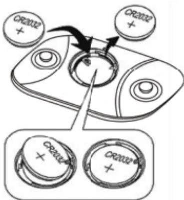
Schließen Sie die Abdeckung des Batteriefachs wieder. Drehen Sie hierzu die Münze im Uhrzeigersinn. Achten Sie darauf, dass die Abdeckung des Batteriefachs richtig geschlossen ist, damit keine Flüssigkeit in die Sendeeinheit eindringen kann.
