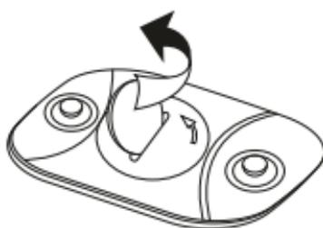
Entnehmen Sie die alte Knopfatterie und legen Sie eine neue Knopfatterie des Typs CR2032 ein. Achten Sie darauf, dass der Pluspol (+) nach oben zeigt und die Batterie unter dem Kontakt liegt.
