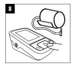
Schalten Sie das Gerät aus. Messungen werden automatisch gespeichert.
